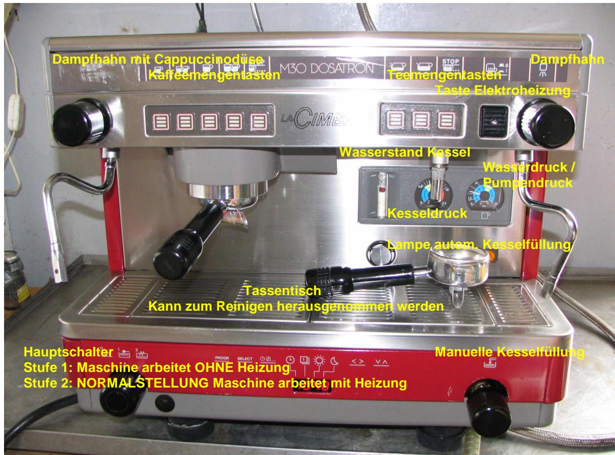
Die Stoptaste bei den Mengentasten dient zum vorzeitigen abschalten und als Dauertaste.
